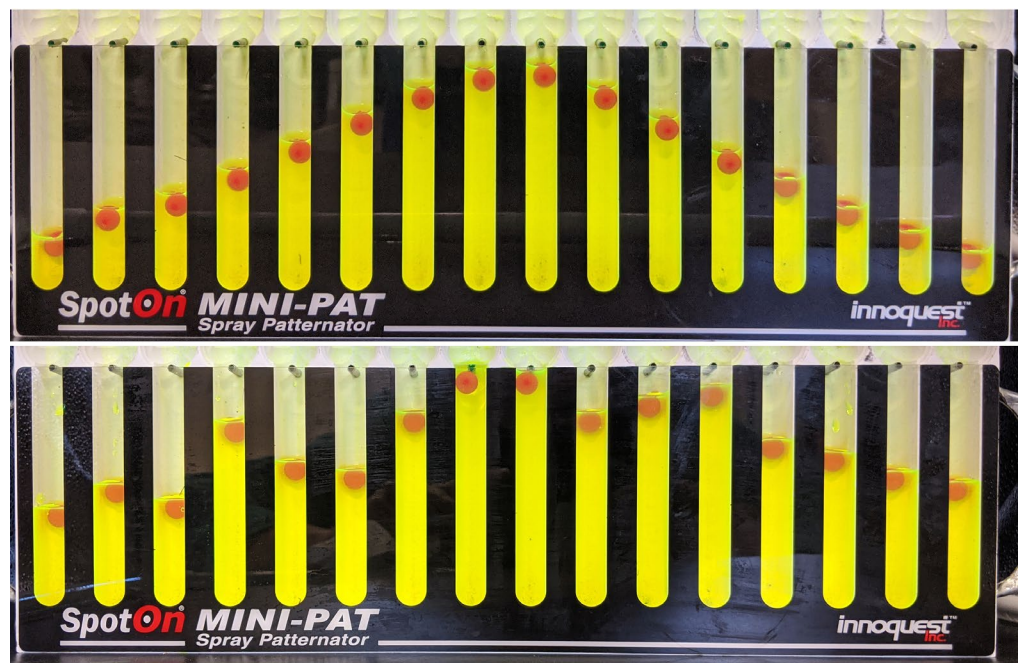
Figura 3. Al probar la boquilla nueva comparándola con la desgastada, el patrón puede mostrar patrones de flujo de salida irregular. Al comparar la boquilla nueva (parte superior) con una boquilla similar utilizada después de una temporada de aplicaciones intensivas de azufre (parte inferior) muestra un patrón de salida muy diferente. Fotografías por Margaret McCoy, Universidad Estatal de Washington.
