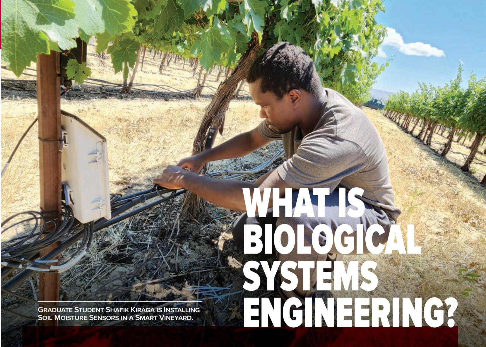
GRADUATE STUDENT SHAFIK KIRAGA IS INSTALLING SOIL MOISTURE SENSORS IN A SMART VINEYARD.
